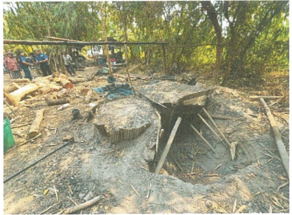
ภาพแสดงไม้ที่เตรียมไว้สำหรับเผาถ่าน และเตาเผาถ่าน
